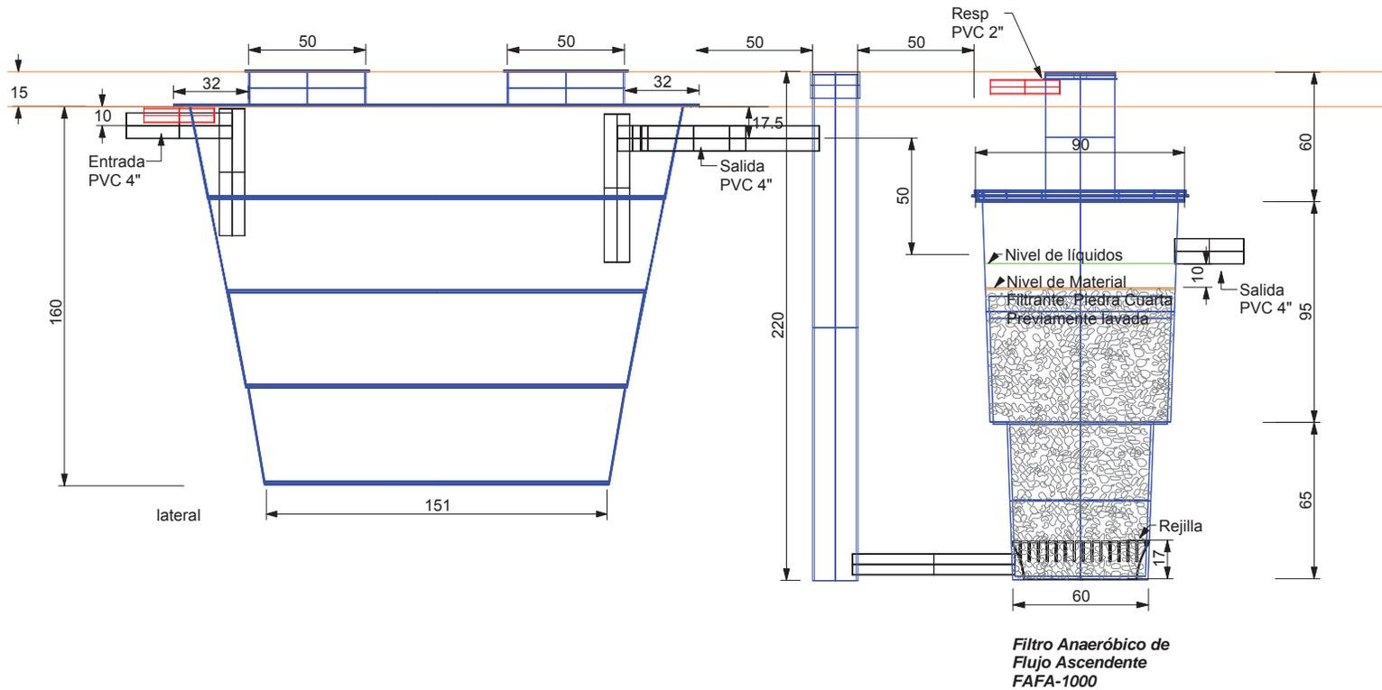
Filtro Anaeróbico de Flujo Ascendente FAFA-1000
