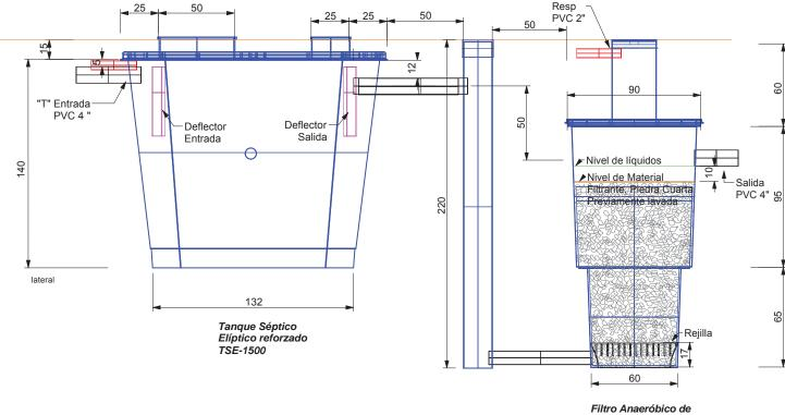
Filtro Anaeróbico de Flujo Ascendente FAFA-1000
