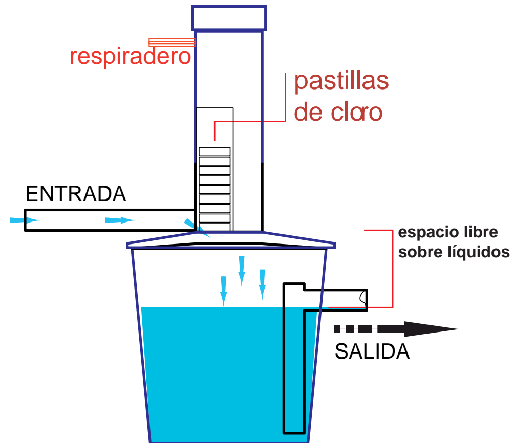
sistema de cloración
